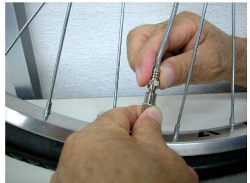
⑥ニップルナット (長) をしめる 注：バルブアダプタが回らないように軽く抑えながらニップルナットをねじ込む
