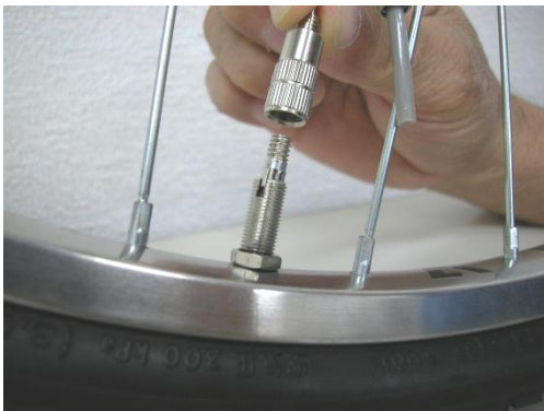
③英式アダプタをステムにねじ込む 注：きつくねじ込み過ぎない事 虫ゴムが切れる恐れがあります
